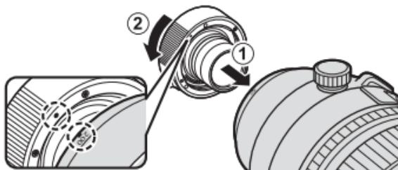
**3** 將增距鏡上的相機安裝標記和相機上的標記對齊 (①)，然後按照圖示方向旋轉鏡頭和增距鏡組合體 (②)，直至其喀嚓一聲卡入正確位置。
