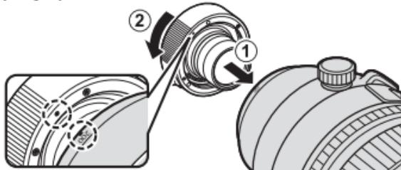
**3** Leg de objectiefbevestigingsindex op de teleconverter op één lijn met de index op de camera (**①**) en draai de objectief- en teleconverterassemblage in de aangeduide richting (**②**) totdat deze op zijn plaats klikt.
