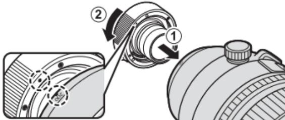
**3** Juster kameraets monteringsmerke på telekonverteren etter merket på kameraet (①) og roter linsen med montert telekonverter i den viste retningen (②) til den klikker på plass.
